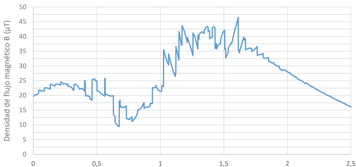
Figura 40. Densidad de flujo magnético ( B[T] = \text{Magnitud } B ) en línea 2 (2L+2T [SUB]).
